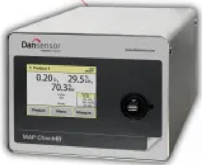
Газоанализатор Damsensor Map Check Pressure O2/CO2 Защита IP40 Время разогрева: 5 мин.
